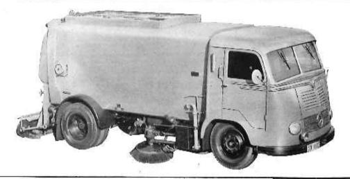
Diesel-Motor · 6 Zylinder · 4-Takt · 90 PS bei 2800 U/min
