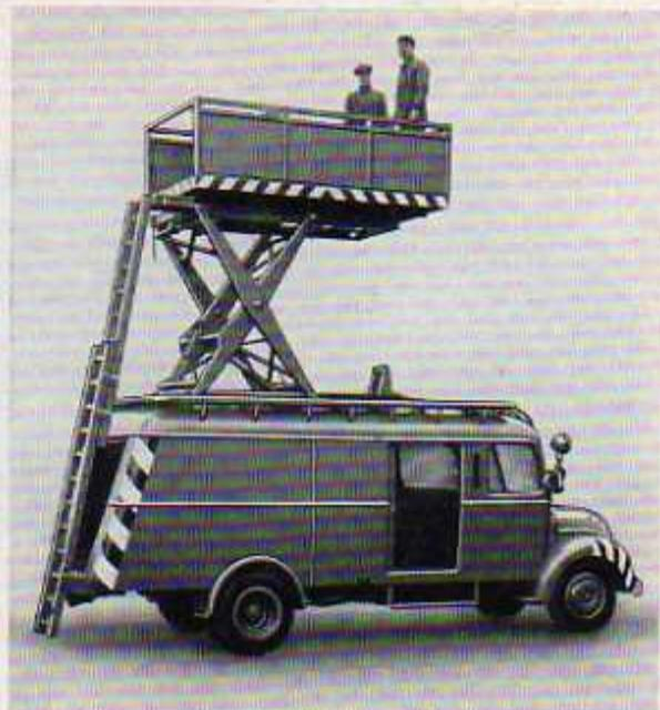
**Oberleitungs- und Montagewagen, System Schörling,** modernste Ausführung, Scherenkonstruktion, großer, freier Innenraum, Besteigen d. Arbeitsbühne dir. v. Fahrzeug aus mögl., Isolationswerte u. Standsicherheit d. Scherenkonstruktion erhöht.
